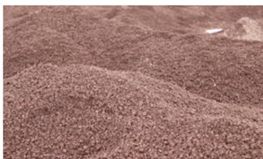
**DAKU ROOF SOIL** è il substrato alleggerito costituito da un mix di materiali minerali di origine vulcanica opportunamente miscelati con sostanza organica. Le sue caratteristiche permettono l'utilizzo nei sistemi estensivi in ridotti spessori (8 cm assestati).
