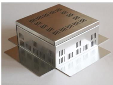
Gli elementi **DAKU CONTROLLER**, realizzati in alluminio-magnesio sono elementi di ispezione di dimensione 25x25cm con altezza standard di 10 cm e consentono l'ispezione degli scarichi in modo agevole e sicuro nelle fasi successive alla realizzazione del verde pensile.
