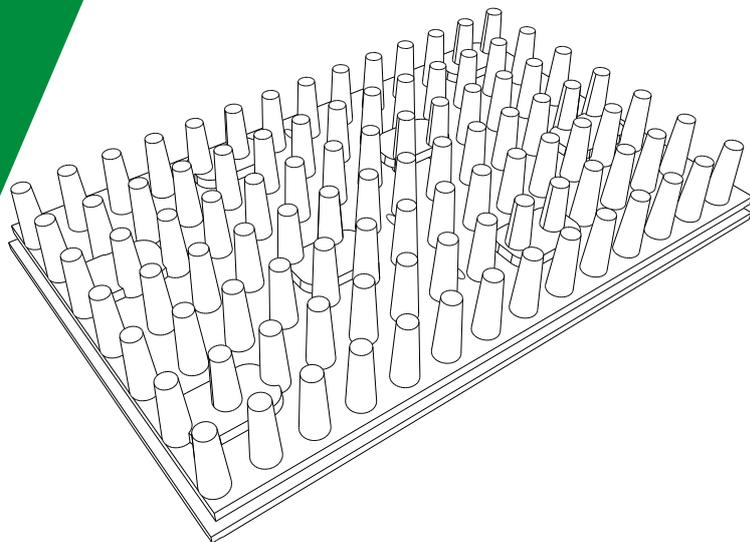
Solitamente vengono riempiti d'acqua per assicurarne la stabilità durante le lavorazioni e consentire lo stoccaggio d'acqua iniziale necessario al momento della piantumazione. Per i punti critici e ovunque non sia possibile installare i moduli a lastre interi, possono essere effettuati tagli con cutter o seghetti, avendo cura di danneggiare il minor numero di celle, per consentire la minor perdita possibile di riserva idrica.
