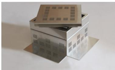
Gli elementi **DAKU CONTROLLER**, realizzati in alluminio-magnesio sono elementi di ispezione di dimensione 25x25cm con altezza standard di 10 cm e consentono l'ispezione degli scarichi. La loro altezza può aumentare con le apposite prolunghe **DAKU RING**, per raggiungere la quota superficiale del pacchetto verde raggiungendo anche altezze multiple.
