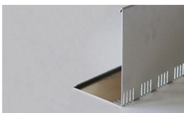
La gamma **DAKU PRO** è rappresentata da elementi di separazione realizzati in lega di alluminio-magnesio. Sono impiegati come elementi di separazione tra i substrati Daku Roof Soil e altri materiali. Vengono collegati alla struttura senza fissaggi meccanici, attraverso la saldatura a sandwich.
