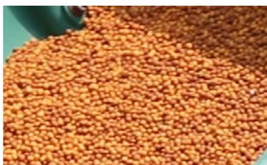
**DAKU PLUS** è un formulato a cessione controllata per tetti verdi. Composto in granuli fertilizzanti ricoperti da una speciale membrana polimerica biodegradabile che consente di regolare il rilascio graduale dei nutrienti in funzione della temperatura del terreno.
