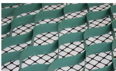
**DAKU GEO** è un sistema di trattenimento costituito da elementi a struttura alveolare antierosiva realizzati in polietilene, di colore verde, costituite da celle ovoidali tridimensionali. Questo dispositivo è inserito laddove le pendenze superano i 18°, evitandone lo scivolamento e contrastando i fenomeni di "ruscellamento superficiale".
