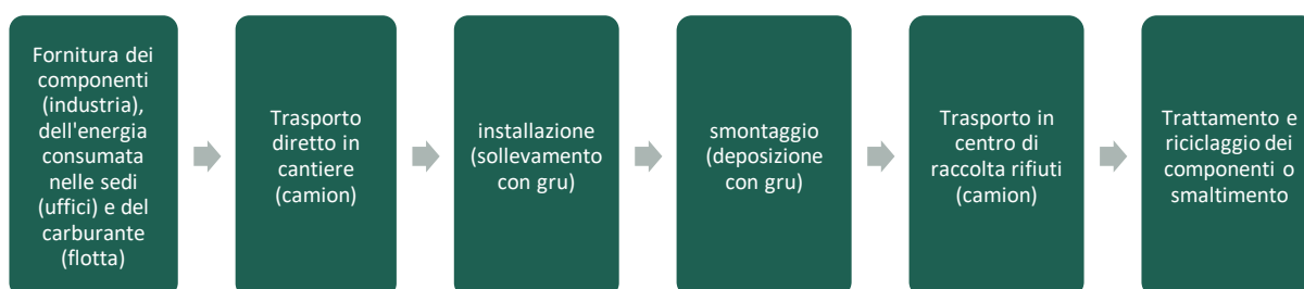
Figura 3 Descrizione delle fasi del ciclo di vita inclusi nella Dichiarazione Ambientale di Prodotto per i sistemi Daku
